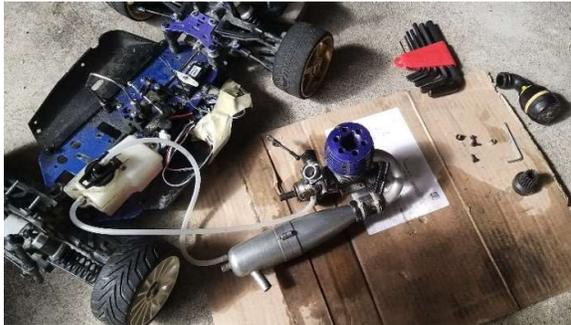
Abbildung 3: Einbau des Tanks und Nitromotors
