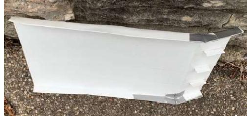
Abbildung 2: Unser selbstgebauter Heckdiffusor
